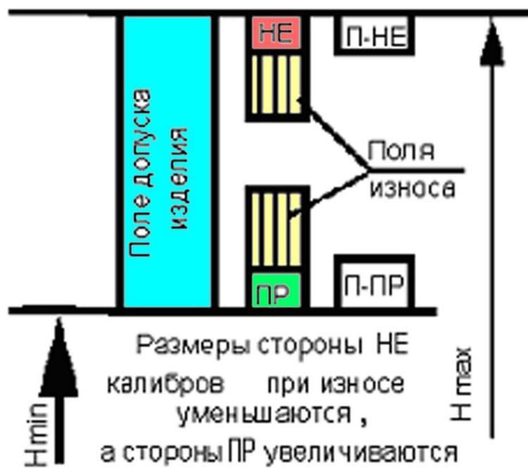
Рисунок 17. Поля допусков калибра для контроля высот уступов (схема 3).
