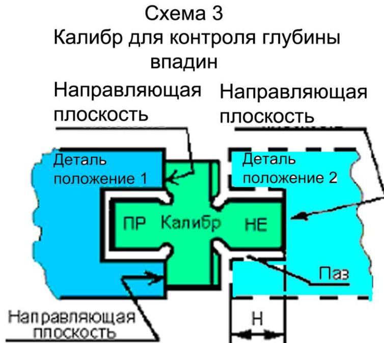
Рисунок 18. Калибр для контроля высот уступов (схема 3).
