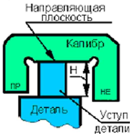
Рисунок 16. Калибр для контроля высот уступов (схема 2).
